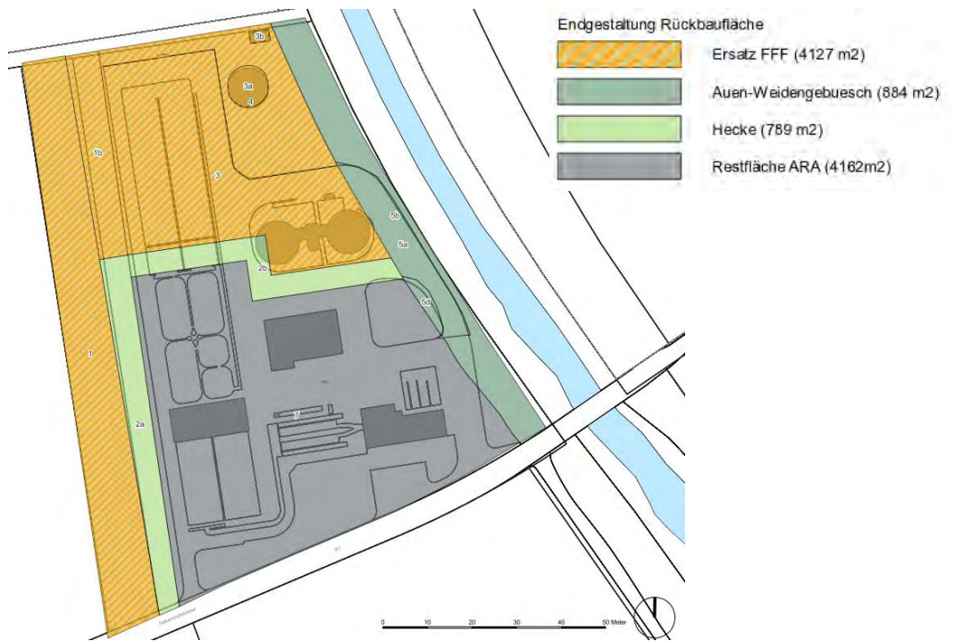
Abbildung 14: Rückbauflächen ARA Falkenmatt mit Aufwertungsflächen FFF (Stand 31.8.2023)
