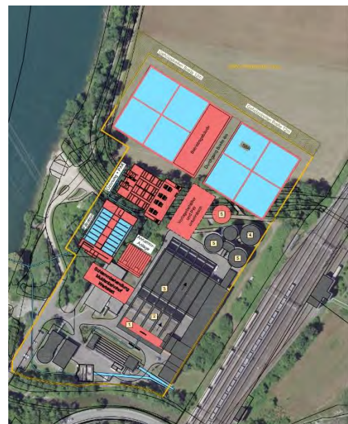
Abbildung 2: Aktueller Projektstand – Erweiterung ARA Langmatt
